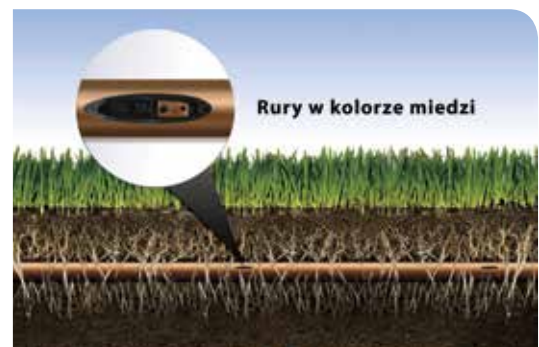
Podziemna linia kroplująca XFS z technologią ekranu miedzianego (Copper Shield™)
