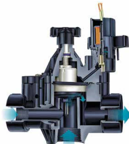
Przekrój zaworu PGA
